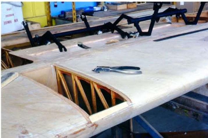
Remplacement de panneaux à l'intrados (4) de l'aile droite
